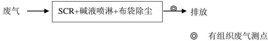
**附 3：锅炉废气测点示意图**
